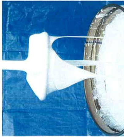
攪拌中、塗料の中に空気を混入させない
