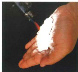
セラミックバルーン断熱実験
